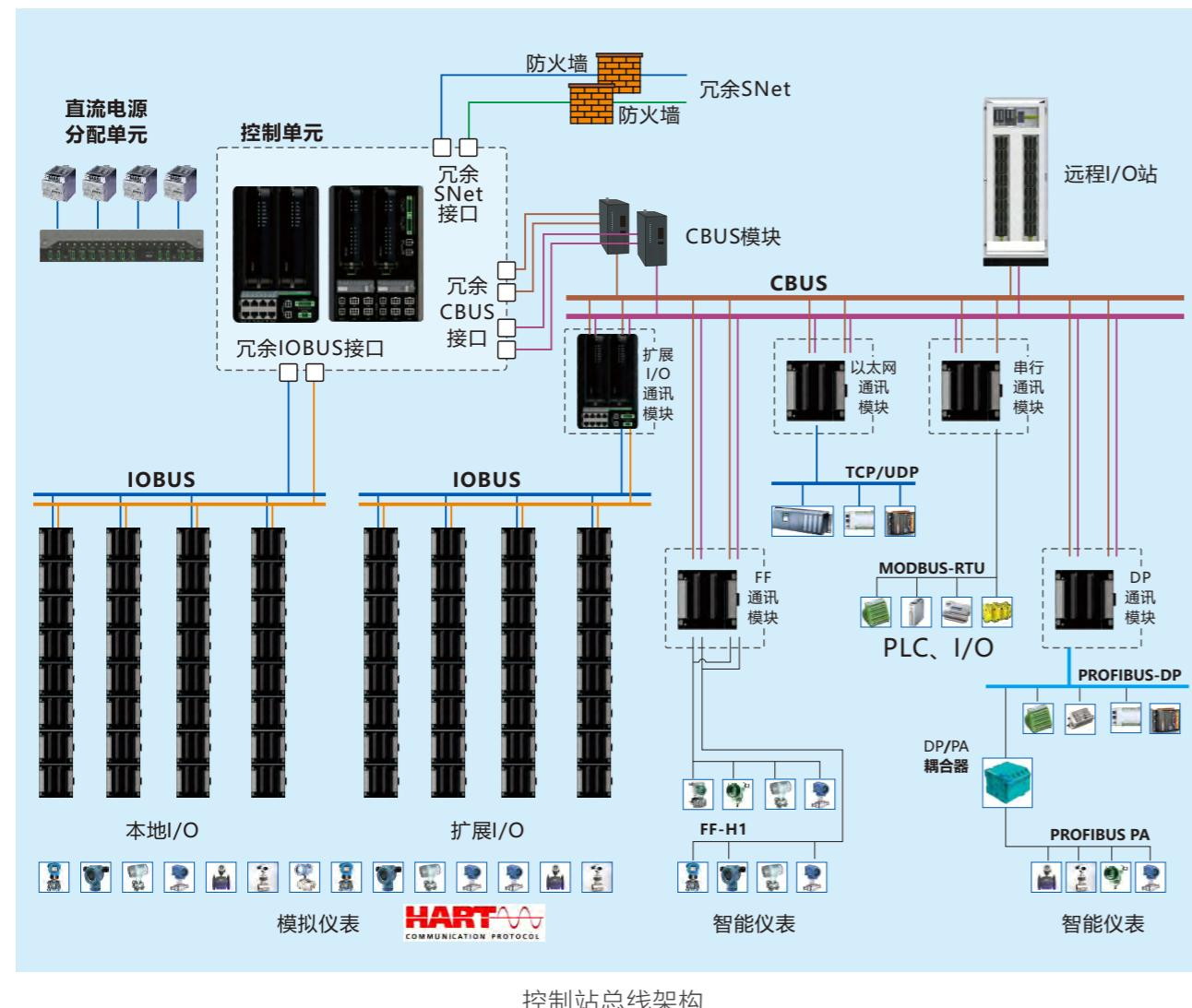
高速控制总线CBUS是基于POWERLINK工业实时以太网技术开发的一种实时网络，实现控制站内部通讯模块与控制模块之间的互联和信息传递。CBUS控制总线通讯速率为100Mbps，属于强实时总线，确保大量数据在较短的固定时间内完成交互，CBUS控制总线通过CBUS模块可以扩展多达8对冗余通讯节点。
