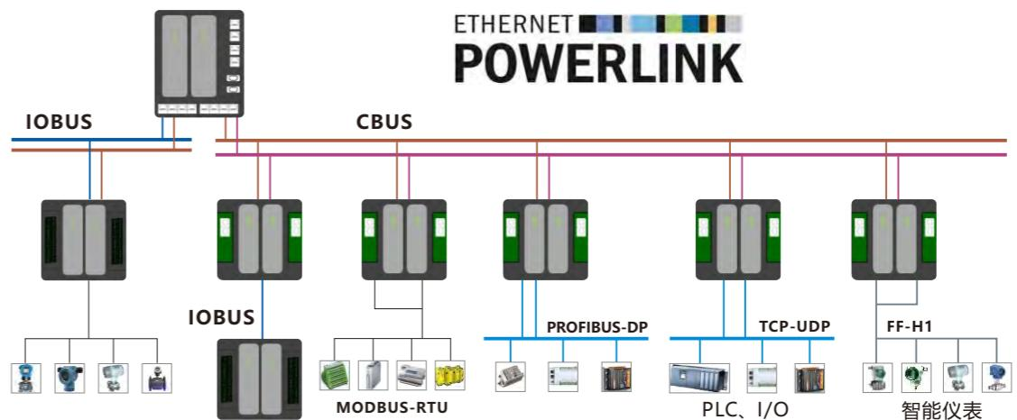
通过CBUS总线连接I/O扩展通讯单元，即可将控制站规模扩大一倍，即增加最多1024/2048点，达到2048/4096点。
